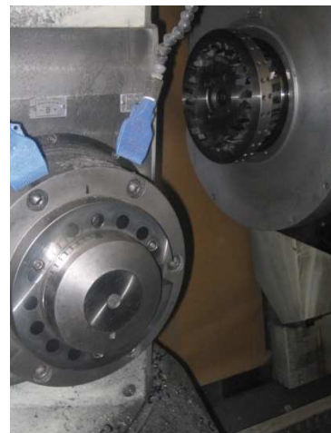
Bild 13.2 Spanndorn zum Fräsen von LKW Tellerrädern
